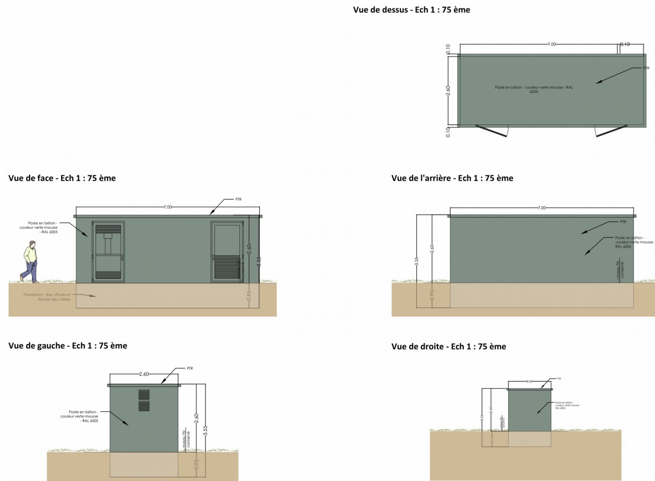
Illustration 78: Plan des façades du poste de transformation
